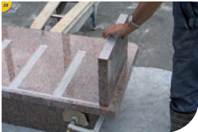
Mise en place des cloisons verticales. (Les trous vers l'avant).
